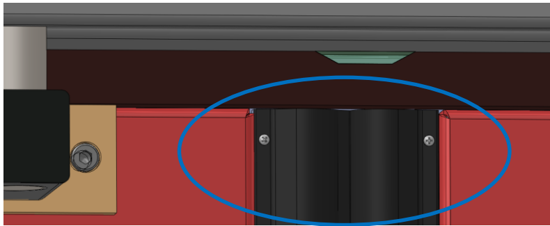
Abbildung 6-20: Abstand an Hauptschließkante
