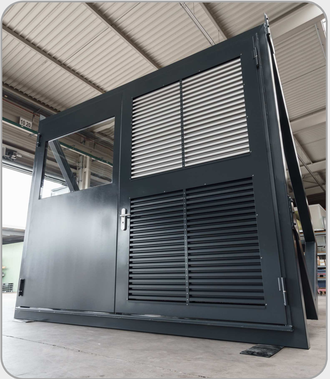
Prüfmuster Einbruchschutz RC-3 mit Panikverglasung und Lüftungsgitter mit Alu- und Stahl-Lamellen
